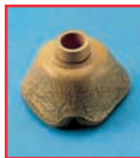
Alterungsriß an einer Atemmaske
