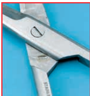
Reibkorrosion infolge fehlender Pflege mit Öl
