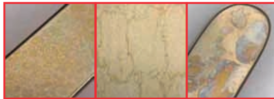
Typische Silikatverfärbungen auf der Instrumentenoberfläche nach der Dampfsterilisation durch zu hohen Kieselsäuregehalt im VE-Wasser.
