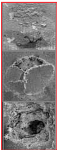
Rasterelektronenmikroskop-Aufnahme, Entstehung chloridinduzierter Lochkorrosion
