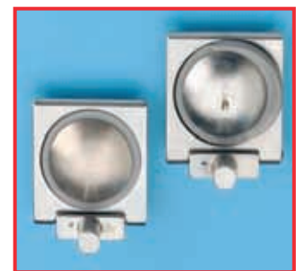
Rechts: Undichtes Klappenventil ei- nes Trokars durch Aufquellung der Dichtung als Folge von Ölkontakt. Links: Neues Klappenventil
