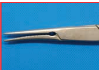
Verformung durch unsachgemäße Handhabung
