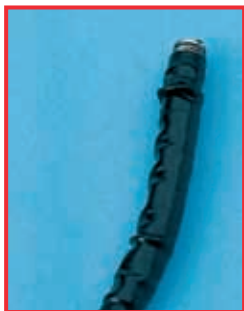
Aufquellung am Distalende eines Fiberskops
