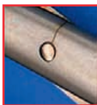
Detail: Schlussgelenk Schere mit typischem interkristallinem Anriss.
