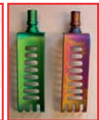
Ausschnitt – Titanvalven: Linke Valve – fabriekneu. Rechte Valve – maschinell gereinigt. Meist erfolgt die Farbänderung gleichmäßig. Sie kann allerdings auch fleckig/mehrfarbig ausfallen.
