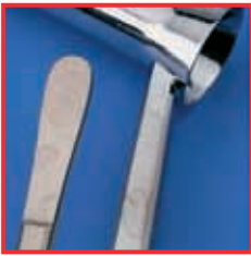
Verfleckungen auf Grund hohen Salzgehalts im Abspülwasser
