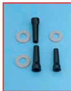
Rechts: Aufgequollene Dichtungen als Folge von nicht gezielt aufgebrachtem Instrumentenöl. Links: Neue Dichtungen
