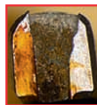
Detail: Maulbruch-Klemme mit typischer körniger, interkristalliner Bruchstruktur.
